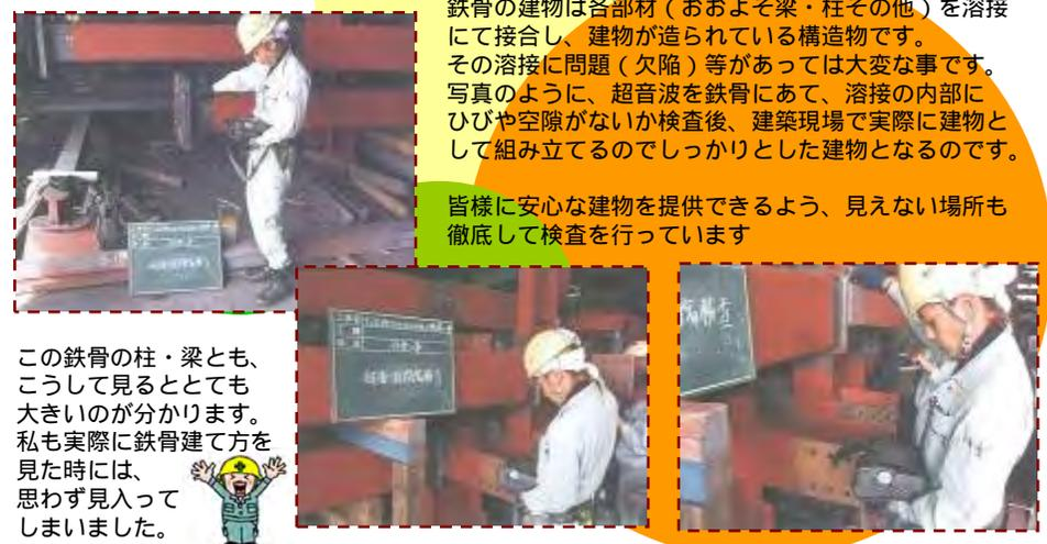
鉄骨の建物は各部材（おおよそ梁・柱その他）を溶接にて接合し、建物が造られている構造物です。その溶接に問題（欠陥）等があるは大変な事です。写真のように、超音波を鉄骨にあて、溶接の内部にひびや空隙がないか検査後、建築現場で実際に建物として組み立てるのでしっかりとした建物となるのです。
